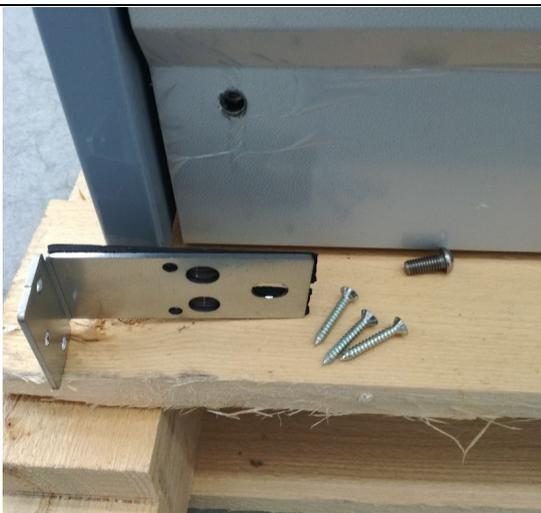
Fig. 6 : rimozione angolare di fissaggio posteriore
