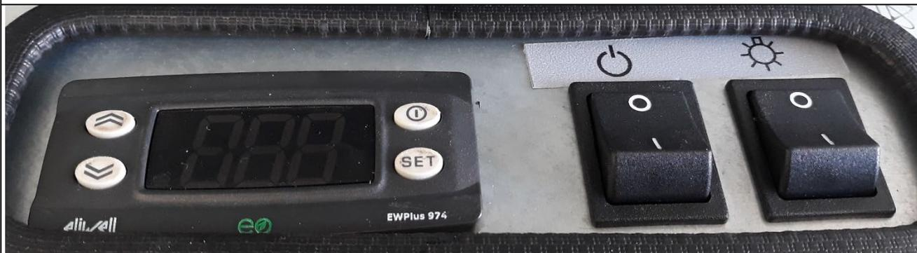
Fig.4: termostato elettronico e interruttori
