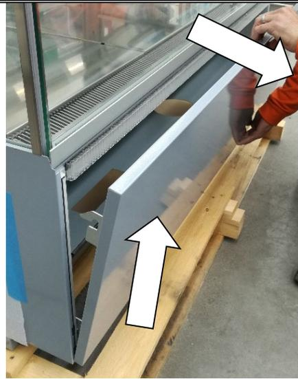
Fig. 5 : rimozione pannello frontale
