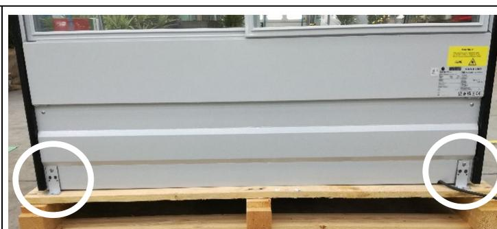
Fig. 3 : Posizione dei fissaggi; lato operatore
