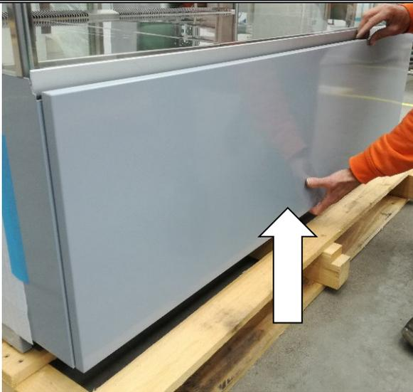
Fig. 4 : rimozione pannello frontale
